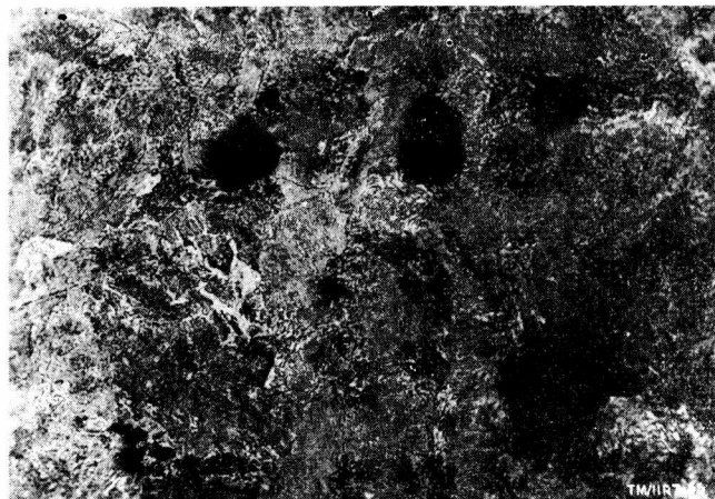
Rys. 7 — Struktura żeliwa ciągliwego perlitycznego, traw. azot. pow. 100 ×.
