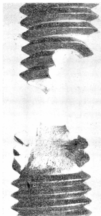
Rys. 6. Śruba łożyskowa zniszczona w czasie próby statycznego rozciągania.
