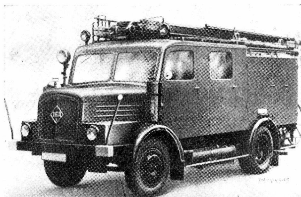
Rys. 3. Samochód gaśniczy niemiecki typu GA15 na podwoziu 3,5 T IFA typ H3A z silnikiem wysokoprężnym 80 KM.
