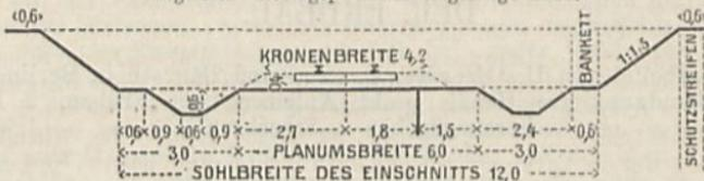
Fig. 352. Abtragsprofil für zweigleisige Bahn.
