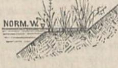
Flussufeln mit Weiden oder, wenn die Pflanzen nicht angehen oder zu leicht zerstört werden, und wenn steile, bis  $\frac{1}{2}$ malige Böschungen unvermeidlich sind, durch Faschinen (Fig. 117, vgl. Flussbau) — letztere sind jedoch nur unter Wasser und bei nicht starkem Angriff desselben, sonst nur im Nothfall zu verwenden; — endlich auch mittels Steinen.
