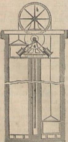
3. Die Fördermaschine\*), Fig. 79, 80, bei welcher die Bewegung der Seiltrommel durch eine Dampfmaschine bewirkt wird, welche zum Vorwärts- und Rückwärts-gang versehen ist. Die Trommeln der Fördermaschinen erhalten Spiralgänge; bei grösserer Länge wird die Trommel mit wechselndem Durchmesser ausgeführt, entsprechend der Veränderlichkeit der Last, welche aus dem Wechsel im Eigen-Gewicht des Seils bei kurzer oder langer Aufwicklung sich ergibt. —
