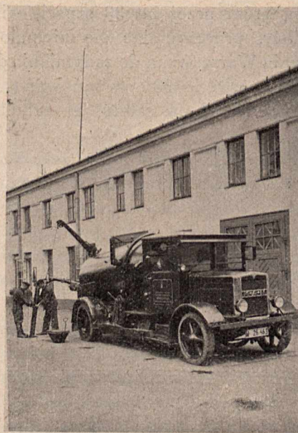
Rys. 15. Spalinowa maszyna do oczyszczania wpustów.
