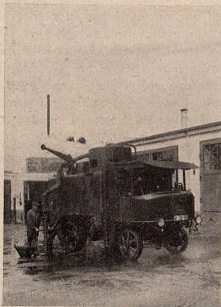
Rys. 14. Parowa maszyna do oczyszczania wpustów.
