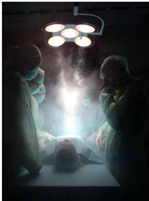
Rys.2.104 Wizualizacja rozplywu powietrza – widok od strony miejsca zajmowanego w rzeczywistości przez anestezjologa; parametry dla wariantu V=1400\text{ m}^3/\text{h} , \alpha=45^\circ , stół poz.1
