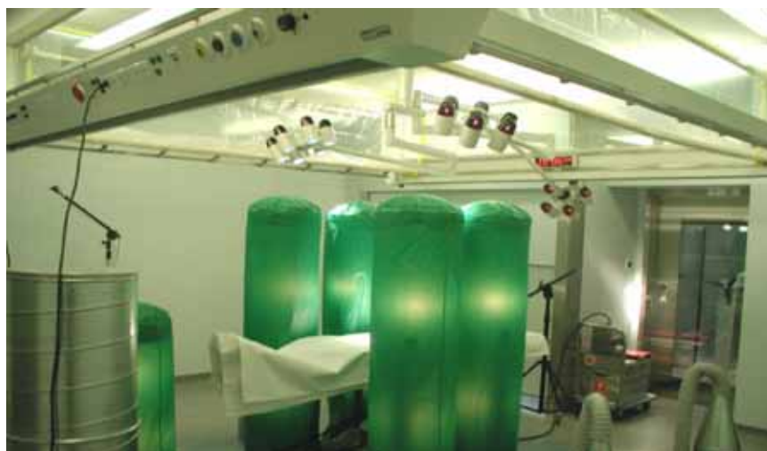
Rys. 1.16 Zdjęcie przedstawiające pomiary prowadzone w jednej z sal operacyjnych szpitala Wetzikon w Szwajcarii, w celu wyznaczenia klasy ochrony zastosowanego systemu klimatyzacji [43]
