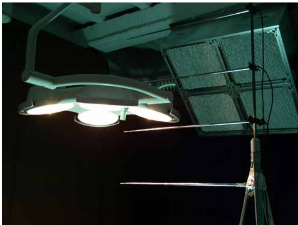
Rys. 2.58 Widok ogólny nawiewnika SLANtinG, lampa bezcieniowa HANAULUX 2005 oraz sondy pomiarowe na wysięgnikach teleskopowych
