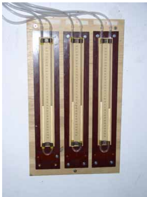
Rys. 2.57 U-rurki do odczytu spadku ciśnienia na kryzach pomiarowych
