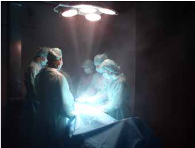
Rys.2.102 Wizualizacja rozplywu powietrza z zasymulowanym zespołem operującym – widok od strony nóg operowanego; parametry dla wariantu: V=1400\text{ m}^3/\text{h} , \alpha=45^\circ , stół poz.1
