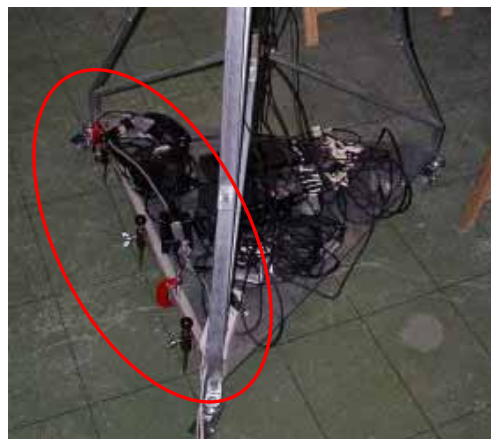
Rys.2.4 Suwnica trójpunktowa-własnej konstrukcji, umożliwiająca kontrolę nad przemieszczaniem się statywu wraz z aparaturą pomiarową; urządzenie umożliwia kalibrację statywu na potrzeby dowolnej siatki pomiarowej
