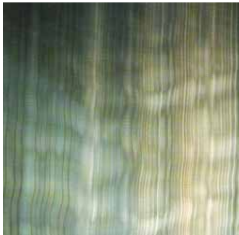
Rys.1.18 Układ strug w idealnym laminarnym strumieniu powietrza [55, 123]
