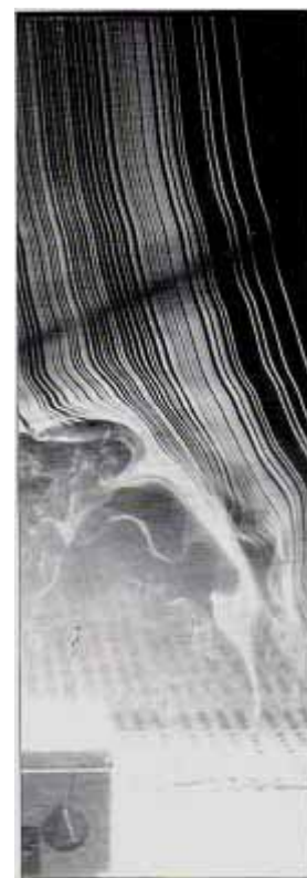
Rys.2.36 Strumień powietrza laminarnego o prędkości 0,33 m/s nad źródłem ciepła [79]
