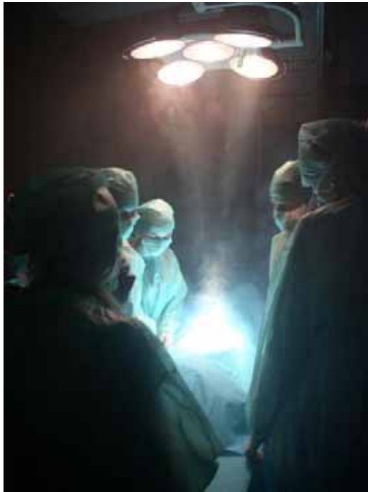
Rys.2.105 Wizualizacja rozplywu powietrza – widok zza pleców anestezjologa; parametry dla wariantu V=1400\text{ m}^3/\text{h} , \alpha=45^\circ , stół poz.1
