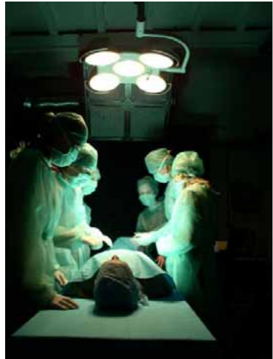
Rys.2.107 Widok stanowiska badawczego od strony głowy pacjenta; sytuacja jeszcze przed zadymianiem; parametry dla wariantu V=1400\text{ m}^3/\text{h} , \alpha=45^\circ , stół poz.1
