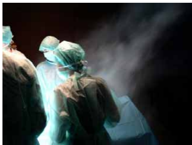
Rys.2.101 Wizualizacja rozptyłu powietrza z zasymulowanym zespołem operującym – widok z boku; parametry dla wariantu: V=1400\text{ m}^3/\text{h} , \alpha=45^\circ , stół poz.1
