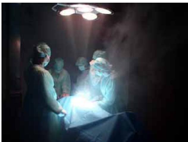
Rys.2.100 Wizualizacja rozptyłu powietrza z zasymulowanym zespołem operującym – widok od strony nawiewnika; parametry dla wariantu: V=1400\text{ m}^3/\text{h} , \alpha=45^\circ , stół poz.1
