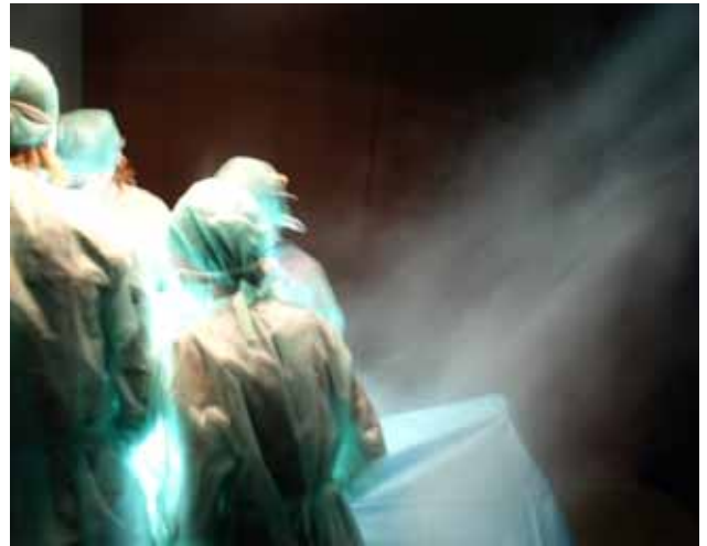
Rys.2.103 Widok strugi nawiewnej wypływającej z nawiewnika (z prawej strony) z zasymulowanym zespołem operującym) oraz samym operowanym; parametry dla wariantu V=1400\text{ m}^3/\text{h} , \alpha=45^\circ , stół poz.1
