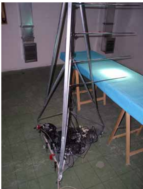
Rys. 2.53 Statyw z sondami pomiarowymi oraz rejestratory wraz z okablowaniem; na dalszym planie widoczne dwie kratki wywiewne; widoczna również namalowana na podłodze siatka pomiarowa
