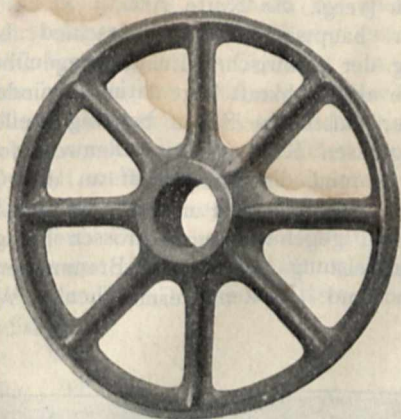
Nahtloses Normal-Speichenrad, Patent Ehrhardt, für 15 t-Radsätze. Gewicht etwa 134 kg.
