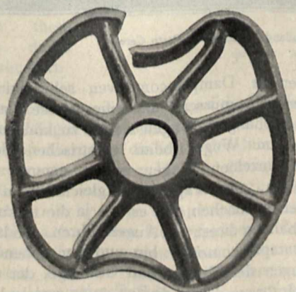
Ansicht eines Rades Patent Ehrhardt nach der Schlagprobe.
