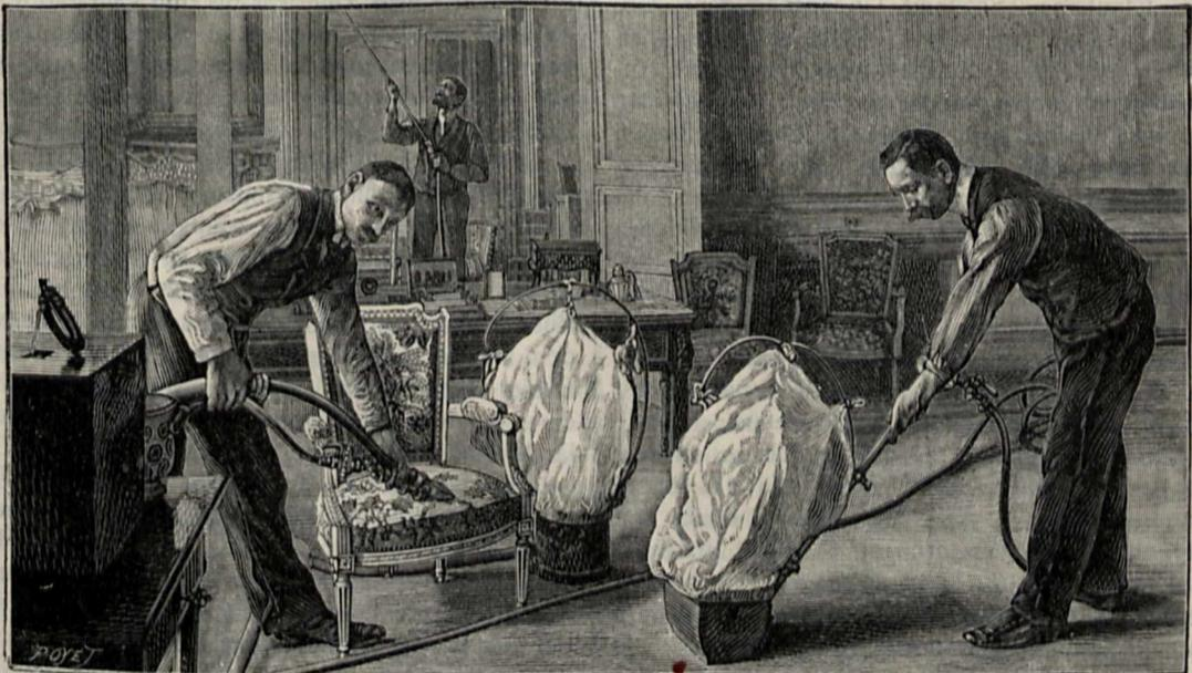
Anwendung des Apparates zum Entstäuben mittels Druckluft (System Thurman).
