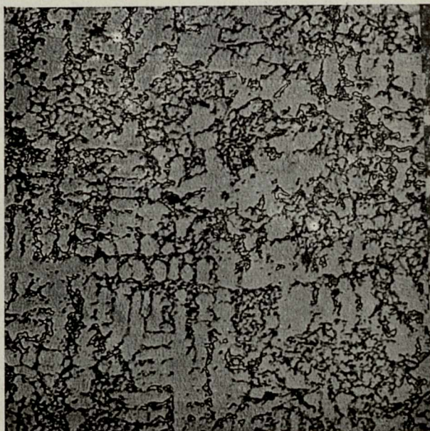
Rys. 10. Grafit eutektyczny, otaczający dendryty ferrytu. Odlew wirowy. Pow. 200 \times \emptyset .
