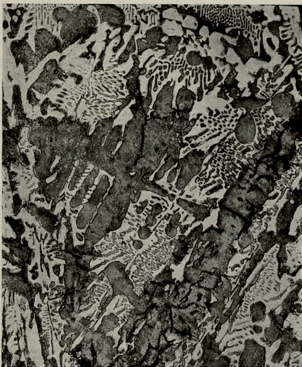
Rys. 9. Odbielona warstwa walca żeliwnego. Małe ilości grafitu występują jedynie w dendrytach perlitu. W ledeburycie nie znajdujemy grafitu. Pow. 200 \times \emptyset .
