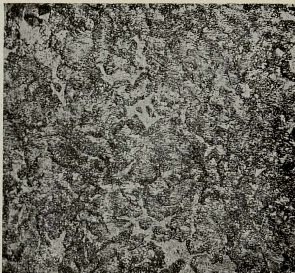
Rys. 13. Warstwa leżąca jeszcze głębiej od pokazanych na rys. 11 i 12. Tło czysto perlityczne. Grafit równomiernie rozsiany. Małe poletka eutektyki fosforowej. Powiększenie 200 \times \emptyset .
