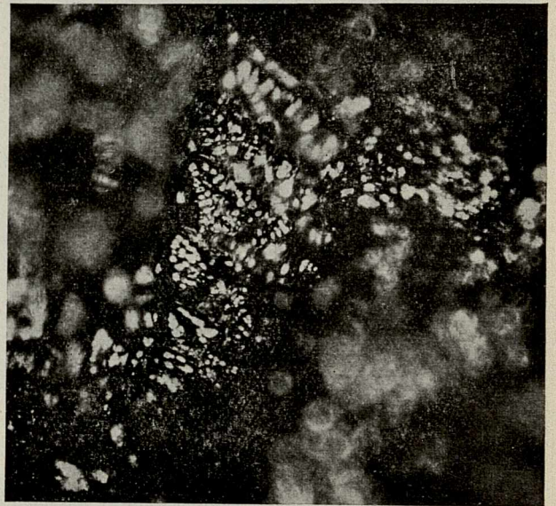
Rys. 1. Przełom odlewu bronzowego (Cu-Sn), obserwowany za pomocą obiektywu EPILUM. Na ostrość nastawione jest zgrupowanie dendrytów roztworu stałego alpha. Nieostre tło spowodowane jest tem, że przełom nie jest płaski. Powiększenie 40 \times .
