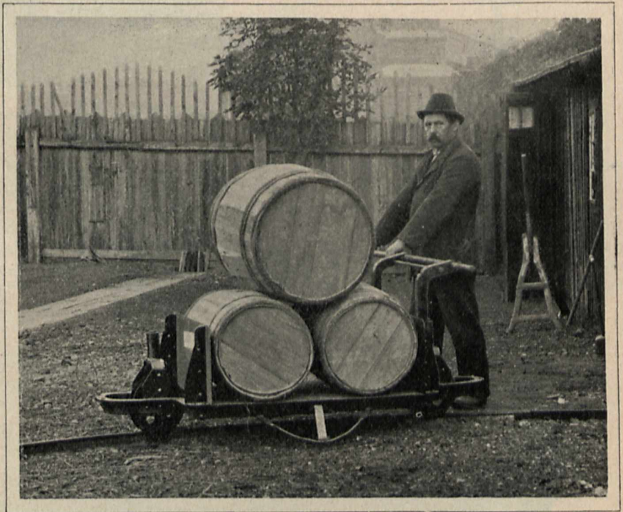
Einschienigenbahnwagen. System Lehmann.
