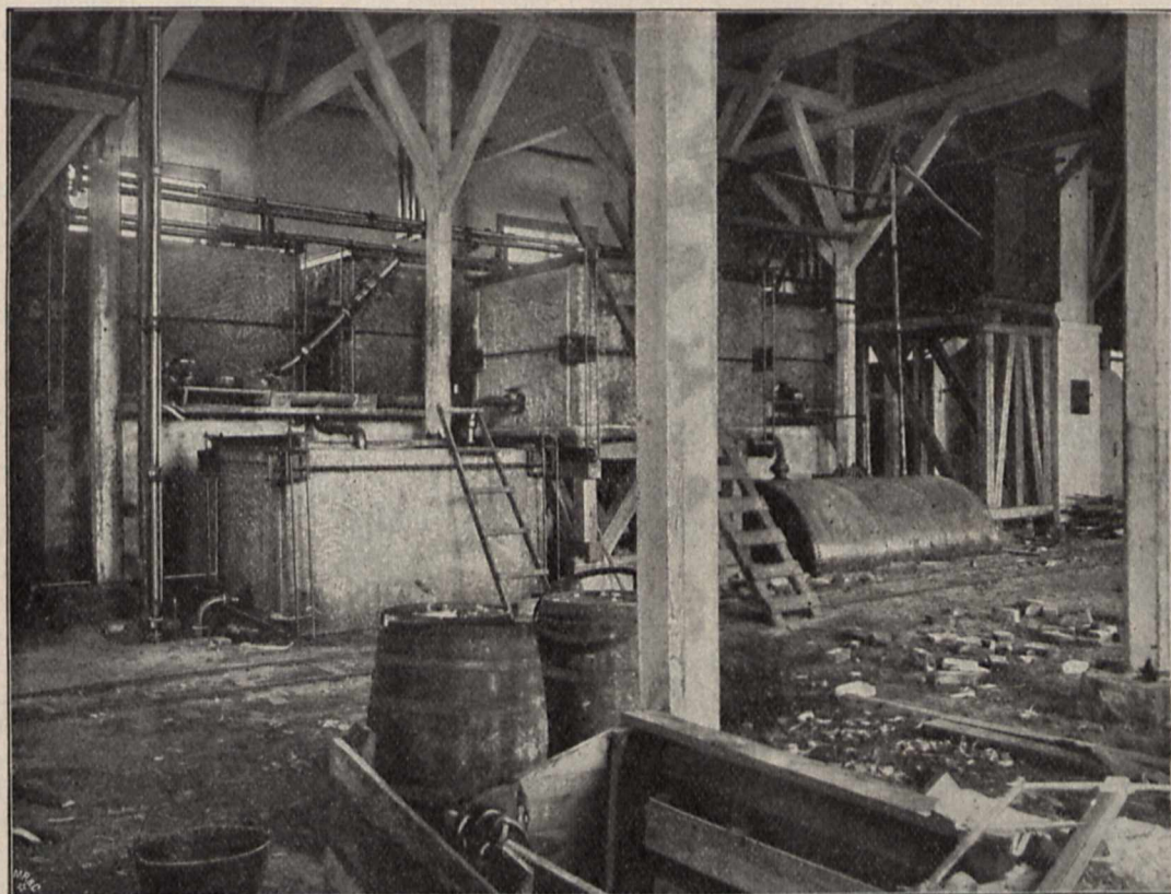
Granitkufen für die Sättigung der Salpetersäure mit Kalkstein.
