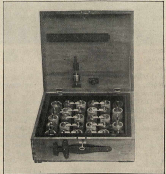
Hochspannungstrockensäule, bestehend aus 30 hintereinandergeschalteten Zambonischen Säulen.
