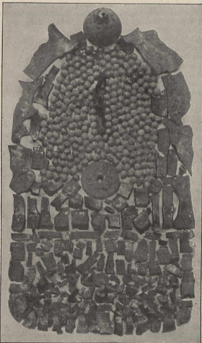
Sprengstücke einer mittels elektrischer Zündung in einer Sprenggrube gesprengten Schrapnellgranate mit längerem Granatteil (s. Abb. 74).
