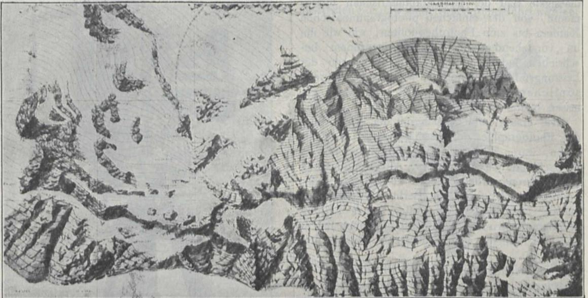
Ausschnitt aus dem Höhenplan der Eigerwand nach dem photogrammetrischen Messverfahren.
