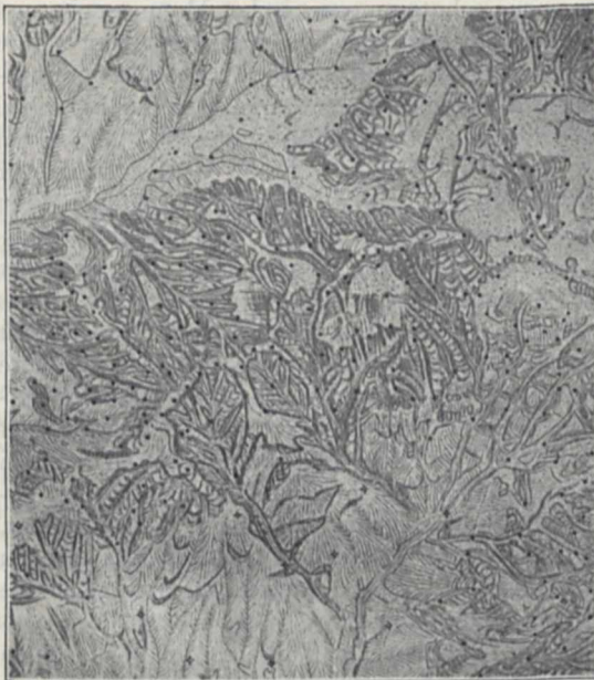
Ausschnitt aus der Mappierung des Gebietes am Razor nach der photogrammetrischen Vermessung (1897/99). Höhenpunkte in der neuen Aufnahme.
