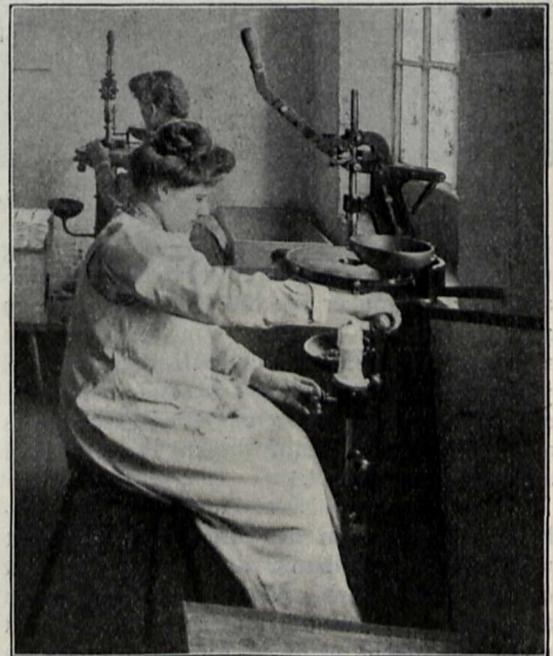
Maschine zur Bildung des Metallkopfes des „Hella“-Glühkörpers.
