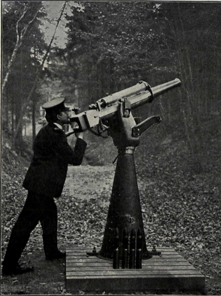
5 cm-Schnellfeuerkanone L/30 der Rheinischen Metallwaren- u. Maschinenfabrik.
