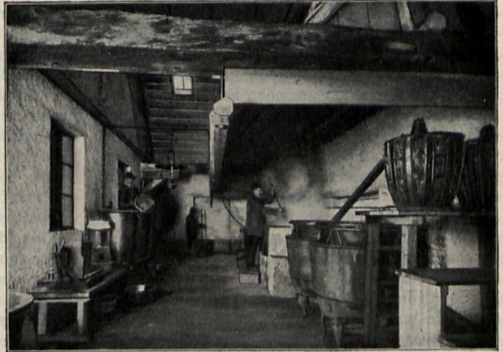
Radiumgewinnung auf Theodorshalle. Arbeitsraum für die groben chemischen Prozesse.
