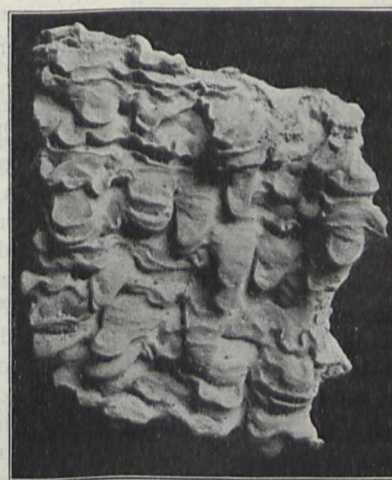
Zungenförmiger Kalkbelag vom oberen Teil der Wandung einer Saturationspfanne; etwa \frac{1}{3} nat. Grösse.
