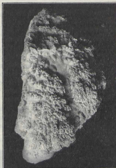
Kalkansatz über einem Schraubenkopf; etwa \frac{1}{3} nat. Grösse.
