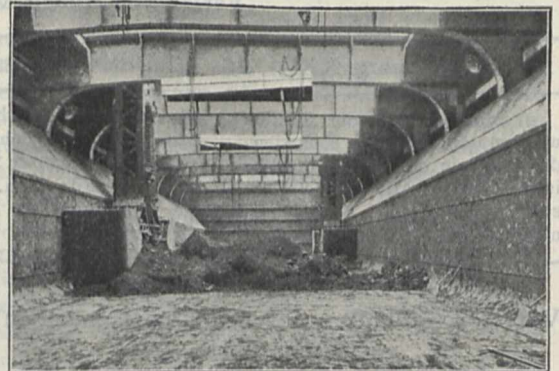
Blick in den Laderaum eines Erzdampfers mit im oberen Teil geneigten Seitenwänden, der durch Selbstgreifer entladen wird.
