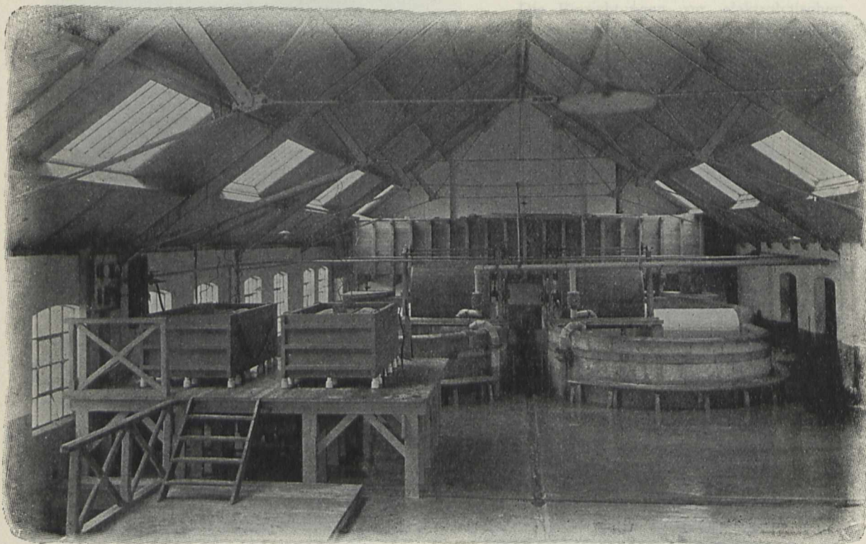
Elektrolytische Bleicheinrichtung für eine Papier- und Cellulosefabrik. Zwei Elektrolyseure hintereinander geschaltet für 240 Volt Betriebsspannung.
