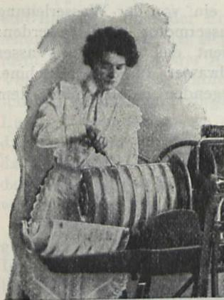
Ablösen des fertigen Eisblockes.
