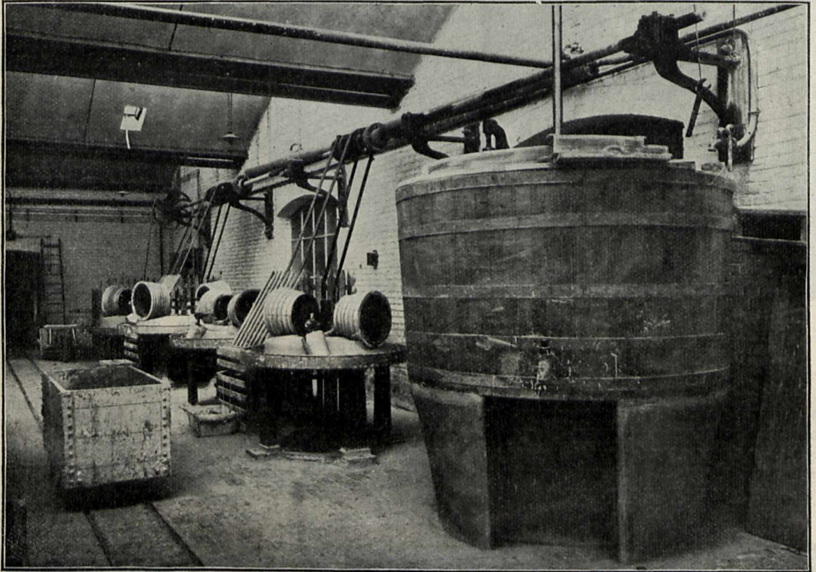
Knetmaschinen in einer Isolatorenfabrik.
