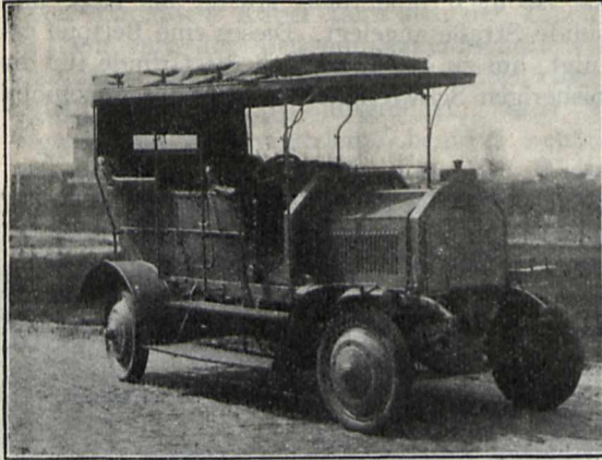
Personenwagen mit Vierräderantrieb für das Reichskolonialamt, geliefert von der Daimler-Motoren-Ges. in Berlin-Marienfelde.
