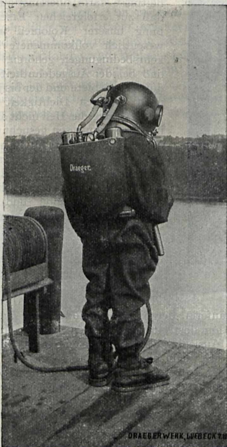
Mit schlauchlosem Dräger-Taucherapparat ausgerüsteter Taucher. Ansicht von hinten.
