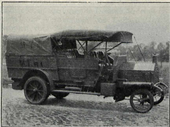
Kombinierter Personen- und Lastwagen, geliefert für Deutsch-Ostafrika von der Daimler-Motoren-Ges. in Berlin-Marienfelde. (Abb. zur Verfügung gestellt vom Kolon. Wirtschaftl. Komitee.)
