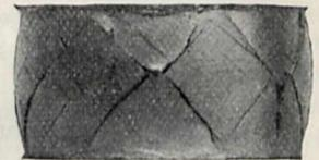
Bruchform beim Druckversuch.
