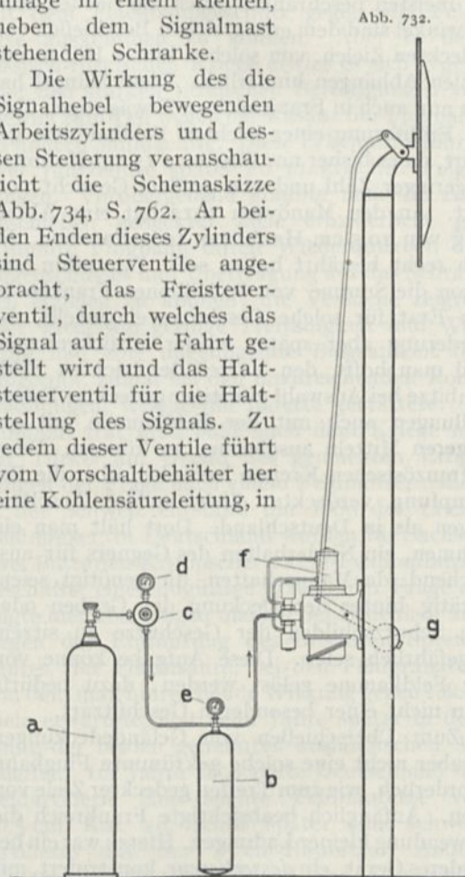
Schema eines durch komprimierte Kohlensäure betriebenen Eisenbahnsignals.
