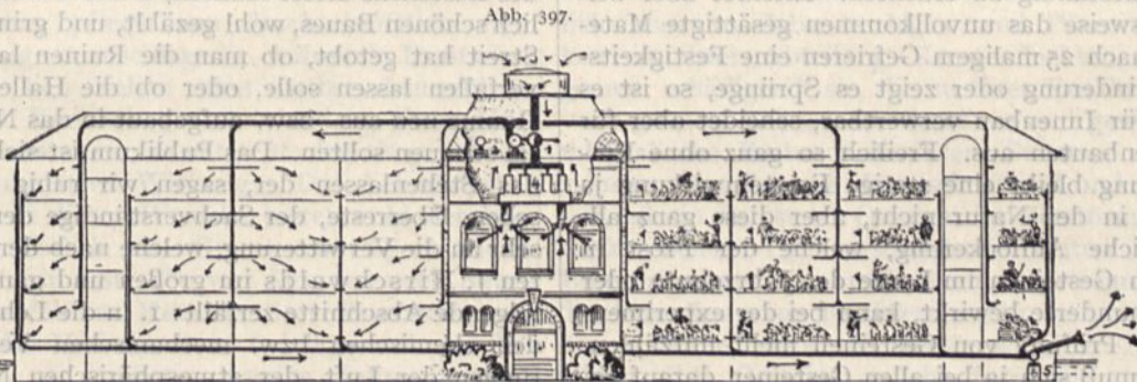
Die Chemnitzer Schüllüftung (von Richard Schippel, Chemnitz-Kappel). 1. Luftbeweg- und Mischmaschine, 2. Elektromotor 2 HP. 3. Kühler, 4. Heizung, 5. Absaugventilator 1,5 HP.
