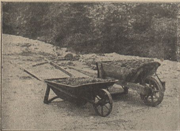
Schnelladeschiebkarre von 100 l Inhalt und gewöhnliche Schiebkarre von 75 l.
