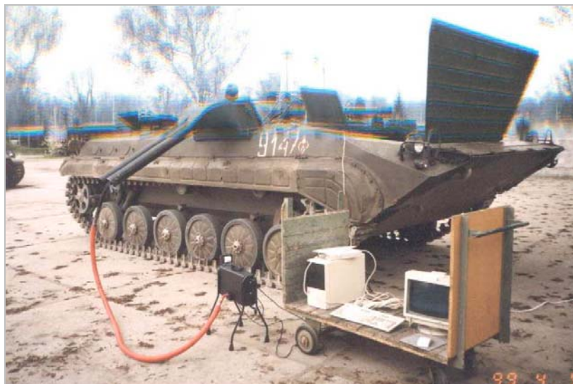
Rys. 5.47. Pomiar zadymienia spalin wozu bojowego
