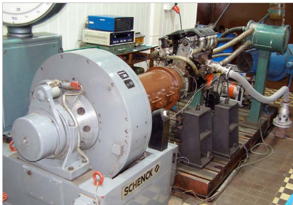
Rys. 5.50. Hamownia silnikowa z hamulcem elektrowirowym SCHENCK 450
