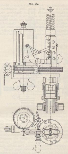
Indikator mit außenliegender Zugfeder von Schäffer & Budenberg (Kaltfederindikator).
