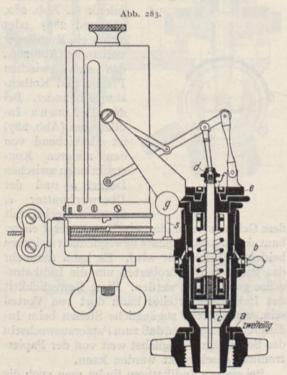
Rosenkranz - Indikator mit innenliegender Feder (Warmfeder indikator).
