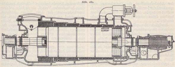
Schnitt einer Parsons-Schiffsturbine mit Kreuzerelement.
