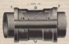
Ansicht der Hilfsmuffe für Rohrreparaturen, auf das gerissene Rohr aufgebracht.
