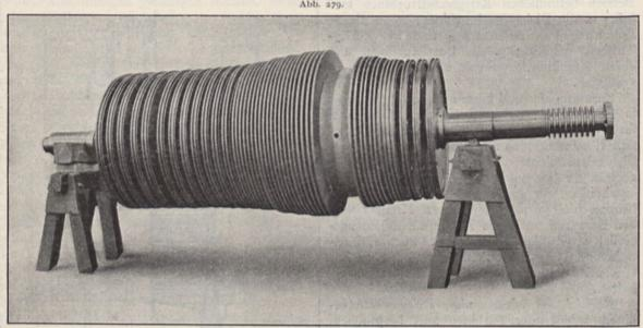
Beschauselter Rotor einer Torpedobootsturbine von Escher, Wyß & Cie.
