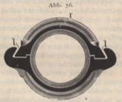
Querschnitt der Hilfsmuffe für Rohrreparaturen.
