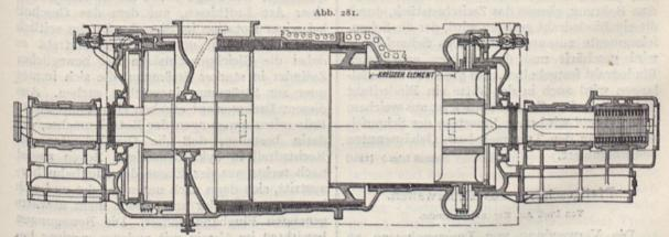
Schnitt durch eine Parsons-Schiffsturbine mit vorgeschalteten Gleichdruckrädern im Hochdruckteil. Vorwarts- und Rückwärtsturbine in einem Gehäuse vereinigt.
