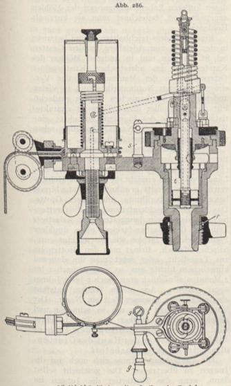
Maihak'-Indikator mit außenliegender Zugfeder (Kaltfederindikator).
