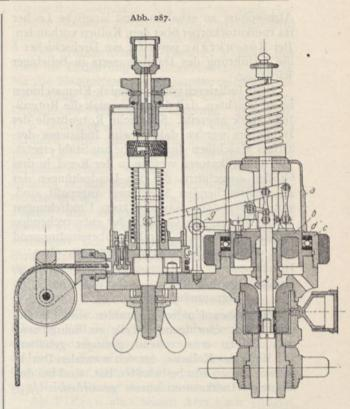
Lehmann-Indikator mit außenliegender Zugfeder (Kaltfederindikator).
