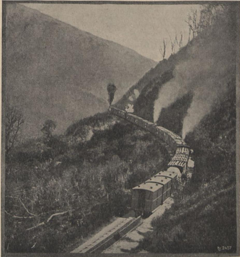
Viehzug, von 4 Fell-Lokomotiven gezogen, auf dem Rimutaka-Abhang. (Neuseeland, Regierungsbahn.) Spur: 1067 mm, Steigung 1 : 15 mit zahlreichen 125-m-Kurven. Gewicht des Zuges, ohne Maschinen, 260 Tonnen.
