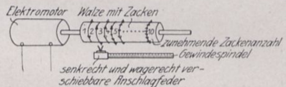
Bild 3. Die Geräusch-Variation nach Intensität (vertikales Heben der Anschlagfeder) und Qualität bzw. Zeit (horizontale Verschiebung der Feder).
