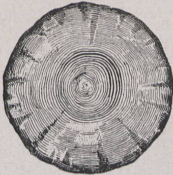
Bild 1. Scheibe von einem kyanisierten Leitungsmast nach Behandlung mit Schwefelkalium, das die mit Sublimat getränkten Stellen schwarz gefärbt hat.
