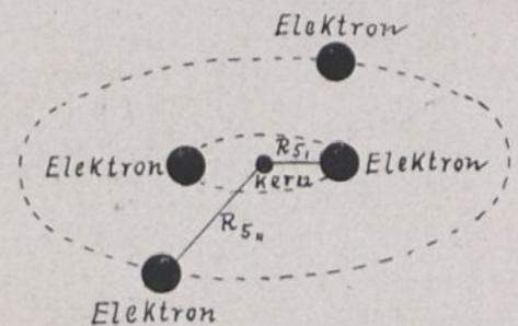
Bild 5. Wahrscheinlicher Aufbau eines neutralen Berylliumatoms.  $R_{5'} = 0,262 \times R_1 \cdot R_{5''} = 0,675 \times R_1 \cdot U_{5'} = 14,6 \times U_1 \cdot U_{5''} = 2,2 \times U_1$ .
