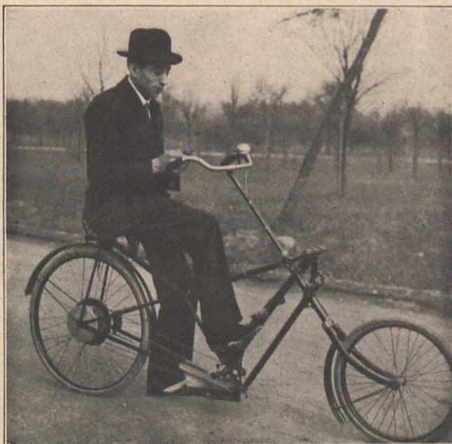
Das J-Rad, bei dem der Kurbelantrieb durch Hebelantrieb ersetzt wird.
