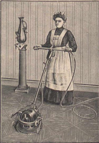
über den Boden geführt wird. Die Bürste ist auswechselbar, je eine dient zum Einwachsen, Blankwachsen oder Reinigen. Die Maschine kann an jeden Steckkontakt einer Lichtleitung angeschlossen werden und verbraucht nur wenig Strom, weniger als ein elektrisches Bügeleisen oder ein elektrischer Kochtopf.
