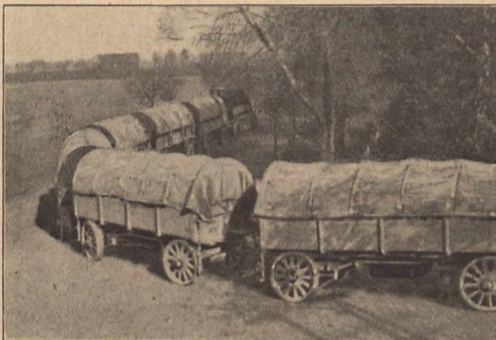
Fig. 1. Müllerzug mit 6 Anhängewagen für 30 t Nutzlast bei 150 PS Motorenleistung.
