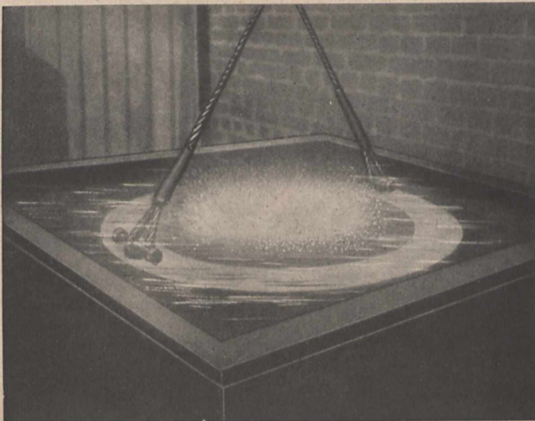
Fig. 2. Unterwasserschall-Sender in Tätigkeit in der Nähe der Wasseroberfläche.
