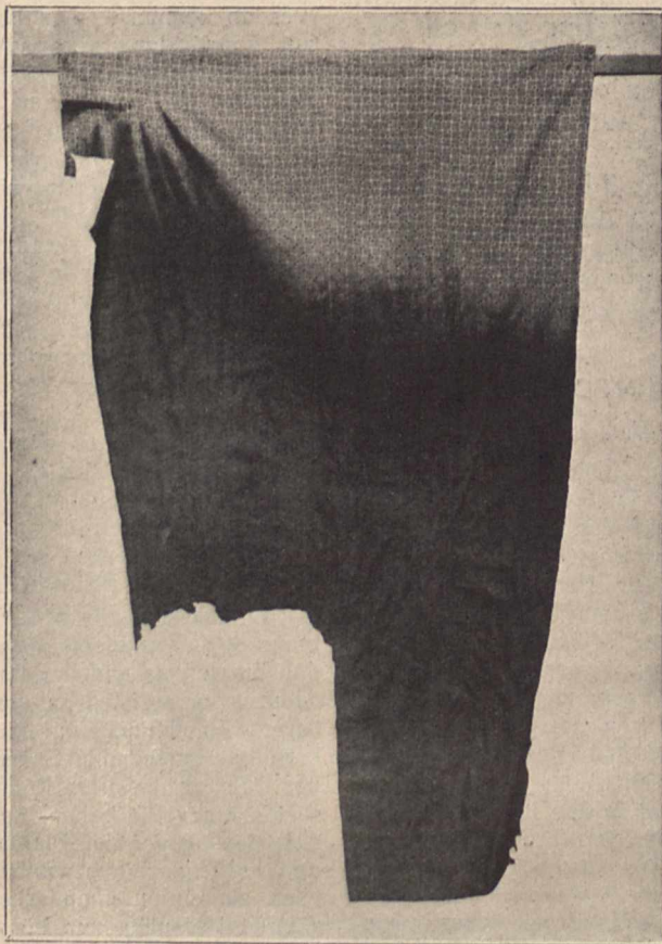
Fig. 1. Ein Kattunstück, welches durch Eintauchen mit Cellon-Feuerschutz getränkt wurde. Nach beendeter Feuerprobe.
