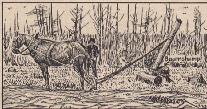
Billige Vorrichtung zum Ausreißen von Baumstümpfen.
