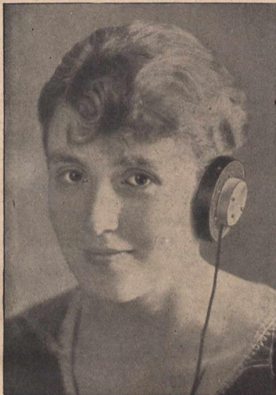
neue Hörer die Ohrmuschel ganz umfaßt, werden alle störenden Außengeräusche ausgeschaltet; ferner wird eine Lautverstärkung gegenüber den bisherigen Hörern um 15–20 Prozent erzielt, und zwar durch ein zwischen Ohr und Membrane schwingendes Luftpolster.
