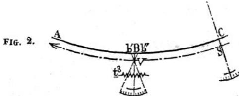
et plus probablement l'une de celles qui sont ponctuées. En tous cas, on tournera la vis de transport  $t^3$  jusqu'à ce que le levier, d'abord éloigné de six divisions, de la ligne du milieu par exemple, en soit rapproché de trois seulement, et on achèvera de le ramener au zéro au moyen de la vis du plomb B.
