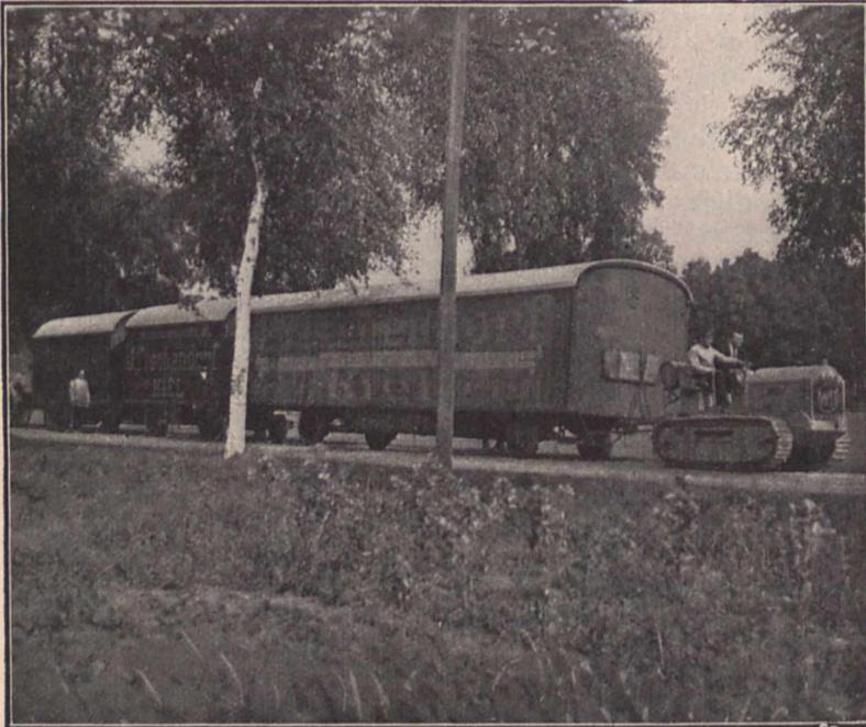
Fig. 1. Der Raupenschlepper beim Transport eines 25 m langen, vollbeladenen Möbelwagensuges.
