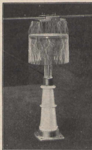
Fig. 2. Glimmschutzvorrichtung nach Meyer. Die isolierende Glasglocke ist bei Ueberspannung von Prasselfeuer überzogen. Dr. Arcularius.
