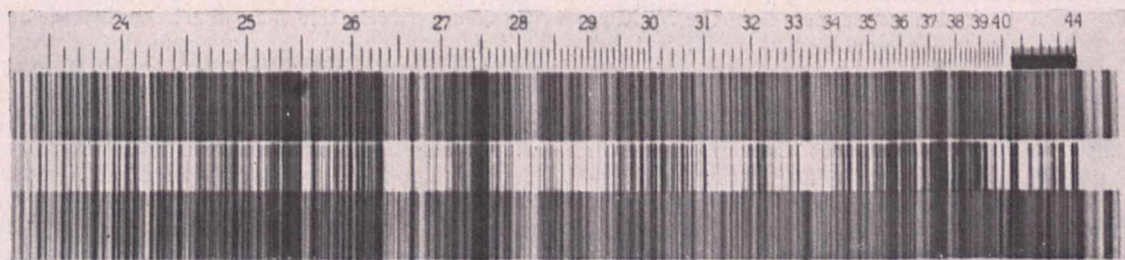
Fig. 3. Das ultraviolette Spektrum [des Eisens mit der Wellenlängenteilung. Die Wellenlängenteilung reicht von 235 bis 410 \mu\mu , also nur knapp in das sichtbare Spektrum hinein. Von den drei übereinander stehenden Spektren ist das mittlere mit künstlicher Verminderung der Linienzahl aufgenommen (durch Selbstinduktion), diese Vereinfachung des Spektrums erleichterte die Fortschritte der Spektralanalyse.
