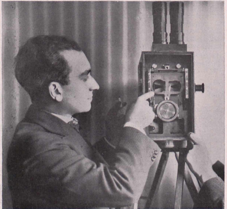
Fig. 2. Die scherenartige Verschlussklappe vor den beiden Objektiven in der Aufnahme-Kamera.
