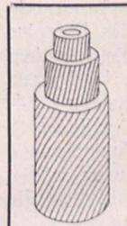
Fig. 4. Schema der Fibrillen-anordnung in einer Bastfaser.
