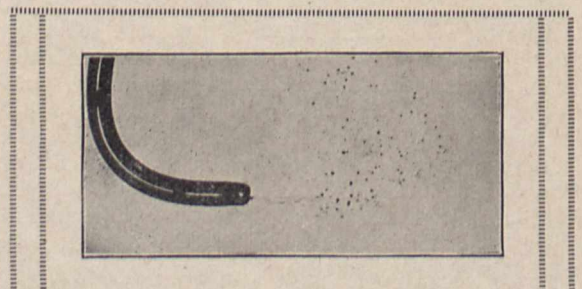
Fig. 5. Bei 220 Volt tritt an der Punktelektrode, gleichgültig ob sie als Anode oder Kathode geschaltet ist, stets die Erscheinung auf wie in Fig. 4b.
