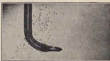
Weg der Gasblasen in verdünnter Schwefelsäurelösung bei 300 Volt Spannung.
