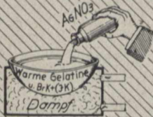
9. Warme jod- u. bromkalihaltige Gelatinlösung wird mit Silbernitrat versetzt. Produkt: Bromsilber-Gelatine, noch wenig lichtempfindliche Emulsion.
