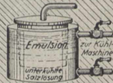
12. Nach dem Ammoniak-Kochprozeß wird die Emulsion schnellstens abgekühlt. Prozeß 11 u. 12 sind für die Lichtempfindlichkeit, Haltbarkeit u. Gradation maßgebend.
