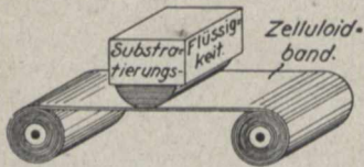
8. Einseitige Behandlung des Filmbandes mit zelluloidangreifenden Stoffen, zwecks späterer besserer Haftung des Emulsionsaufgusses (Substratierung).
