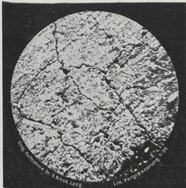
Fig. 1. Rissig gewordene Autobereifung vor Behandlung mit „Sparegum“.
