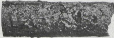
Fig. 6. Gewöhnliches Flußeisen, 200 Stunden bei 860° bis 900° C gegläht.
