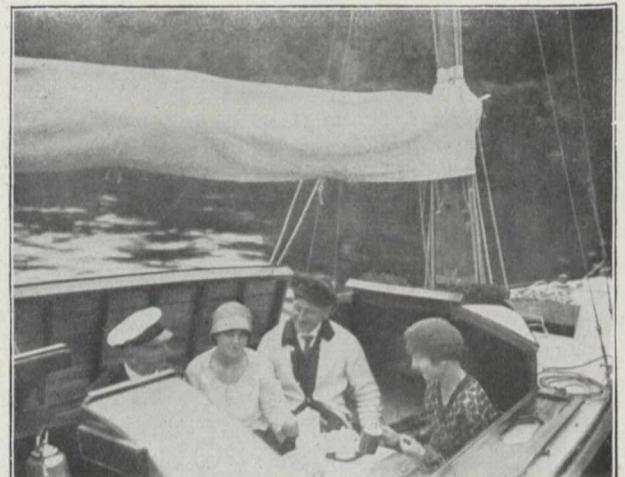
Fig. 2. Die „Freiluftkajüte“ geöffnet. Dach und Seitenwände sind in den Angeln umgelegt.
