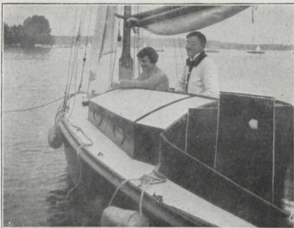
Fig. 1. Die geschlossene „Freiluftkajüte“ unterscheidet sich nicht von der üblichen Bauart.
